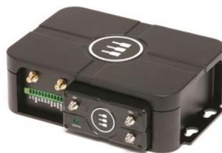
processore Freescale i.MX6 Solo Core, ottimizzato per prestazioni di calcolo elevate con consumi efficienti, il gateway multiservice ReliaGATE 10-20 è un dispositivo intelligente e robusto che offre funzionalità di comunicazione, potenza di calcolo e un'infrastruttura applicativa semplificata per l'integrazione di una piattaforma M2M e applicazioni di servizio.
