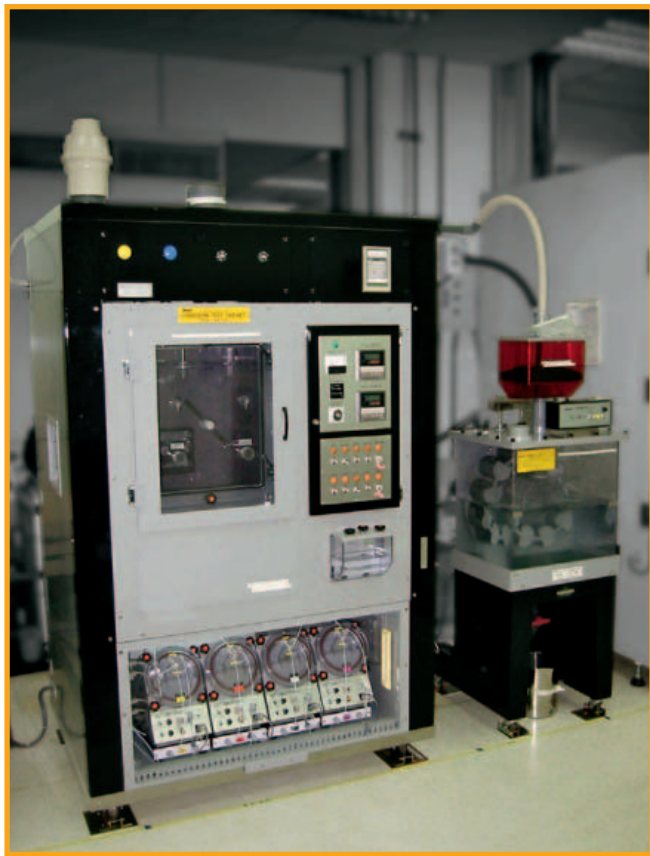
Fig. 4 – Una camera di test Everlight dove sono simulati gli effetti dello zolfo sui componenti
