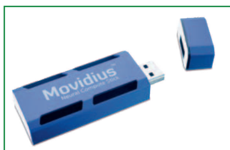
Movidius Neural Compute Stick è un piccolo dispositivo senza ventola prodotto da Intel per sviluppare e prototipare applicazioni di intelligenza artificiale (IA)
