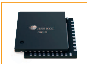
Fig. 1 – MasterHIFI Audio DAC Cirrus Logic CS43130 con 512 canali di conversione e doppia uscita di 30 mW su 32 Ohm e 5 mW su 600 Ohm
