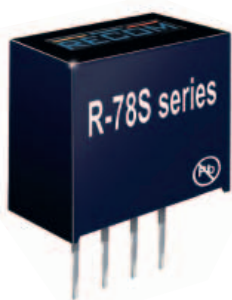
Fig. 1 – Il regolatore a commutazione boost R-78S non solo allunga la durata delle pile nelle applicazioni IoT, ma ne sfrutta completamente la carica
