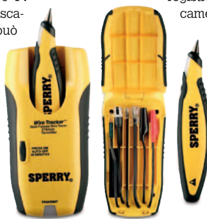
Fig. 4 – Il Wire Tracer ET64220 consente di tracciare la continuità dei cavi di rete e dei doppini audio, video e dati per verificarne rotture o perdite
