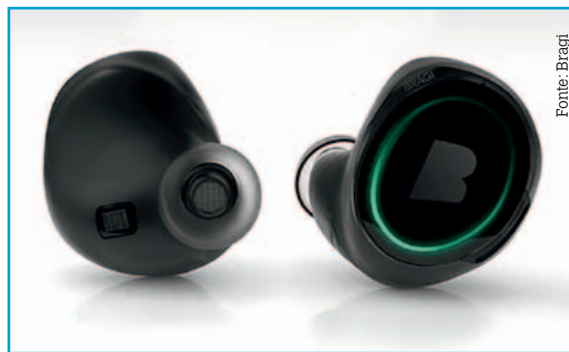
Fig. 2 – Tra i dispositivi di nuova generazione che stanno "mettendo a dura prova" i limiti della capacità delle celle vi sono le cosiddette cuffie "true wireless" (senza cavo): si tratta di auricolari che non prevedono cavi per la connessione sia tra i due auricolari sia con il dispositivo host wireless, come nel caso dei questi auricolari di Bragi
