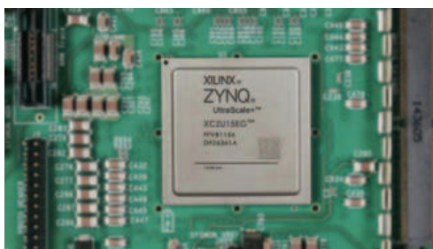
Fig. 4 – Xilinx ha pensato i MPSoC Zynq UltraScale+ per la gestione della moltitudine dei segnali automotive caratterizzandoli con un'ampia versatilità di configurazione
