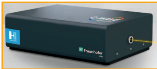
Fig. 4 – L'ampia gamma delle lunghezze d'onda disponibili unitamente alla linearità della risposta e alla semplicità d'uso fanno del C-WAVE uno strumento particolarmente efficace nella spettroscopia
