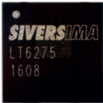
Fig. 7 – Garantiscono 5 Gbps da 57 a 71 GHz i transceiver TRX 1608-LT6275 e TRX BF01 che Sivers IMA produce con transistor in SiGe caratterizzati dalla frequenza di taglio di 300 GHz
