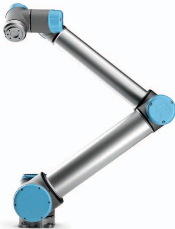
Fig. 5 – Universal Robots UR10 è una macchina con payload di 10 Kg, reach di 1.300 mm e 15 funzioni di sicurezza per garantirne la massima affidabilità
