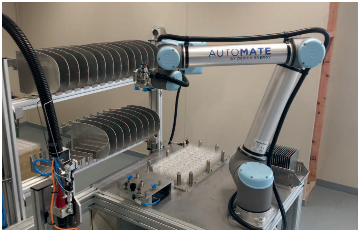
Fig. 2 – Il robot collaborativo di Universal Robots elimina il rischio di perdere la vite, assicura un buon contatto termico tra la scheda LED e la piastra di base e garantisce il corretto posizionamento delle lenti
