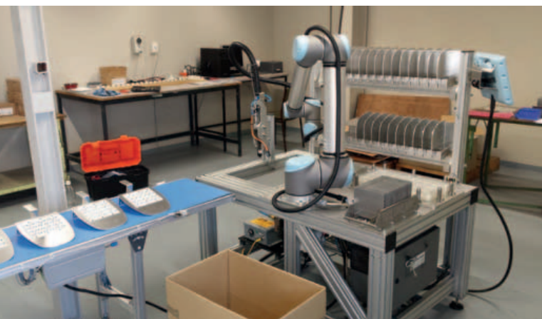
Fig. 4 – UR10 utilizza un gripper multi testa che effettua il vuoto per raccogliere un circuito da un rack, prelevare sei lenti Led e un nuovo utensile, un cacciavite automatico, per il fissaggio
