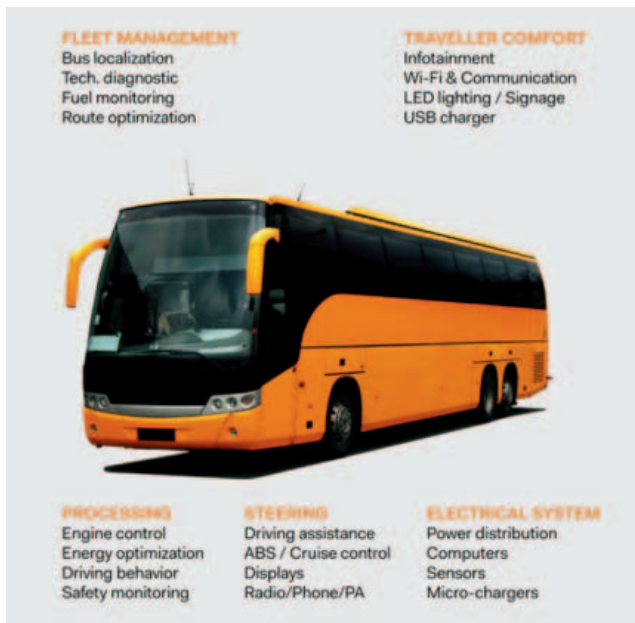
Fig. 3 – Applicazioni installate su bus moderni che richiedono un'alimentazione stabile oltre ad alcune batterie locali per funzioni di sicurezza
