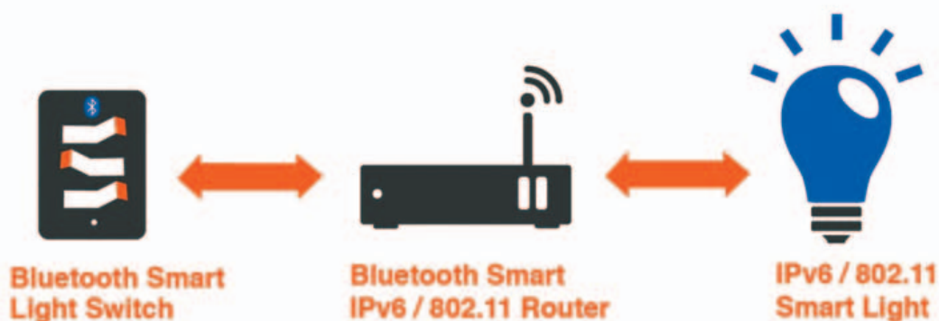
Fig. 2 – La funzionalità IPv6 prevista da Bluetooth 4.2 consente ai dispositivi Bluetooth Smart di comunicare con altri nodi terminali Internet (Fonte: Bluetooth SIG)
