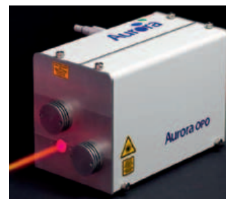
Fig. 4 – Il laser per imaging fotoacustico Litron Lasers Aurora OPO genera impulsi con durata di 7 ns e larghezza di riga di 5 \text{cm}^{-1} nelle lunghezze d'onda che vanno da 410 a 680 nm
