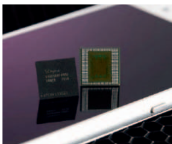
Fig. 3 – Le memorie LPDDR4X di SK Hynix con capienza di 16 Gbit hanno gli I/O da 64 bit alimentati a 0,6 V per una velocità di trasferimento dati di 34,1 GByte/s
