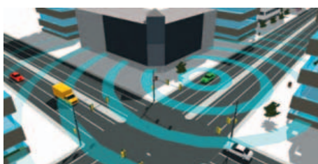
Fig. 1 – Le soluzioni V2X permettono ai veicoli di scambiare messaggi con gli altri veicoli e con i punti di segnalazione distribuiti a bordo strada in modo da ottimizzare la guida in funzione delle condizioni ambientali
