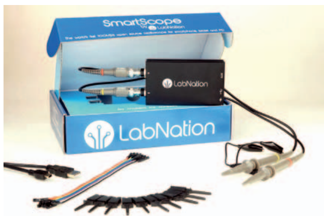
Fig. 4 – Serve una connessione USB per lo SmartScope di LabNation che ha un'impostazione open-source e offre all'ingresso due canali analogici con campionamento a 100 MS/s e impedenza di 1 MOhm//10 pF
