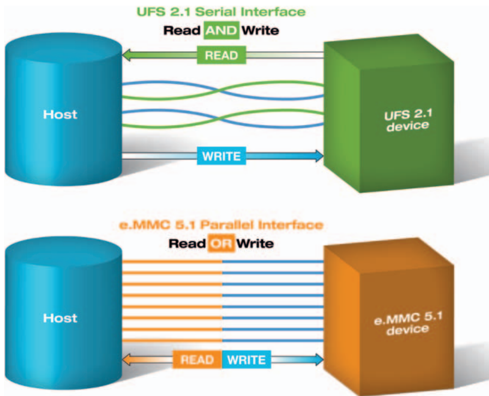
Fig. 4 – La tecnologia d'interfaccia seriale Universal Flash Storage è bidirezionale e permette di scrivere e leggere dati simultaneamente fino a 1,2 GByte/s che raddoppieranno a 2,4 GByte/s nella versione 3.0
