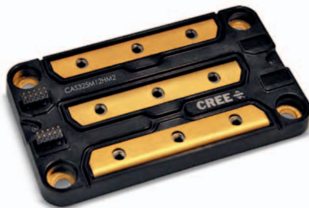
Fig. 7 – Contiene sette Mosfet SiC e sei diodi Schottky il modulo di potenza CAS325M12HM2 che Wolfspeed propone per le applicazioni automotive più impegnative fino a 1,2 kV e 325 A
