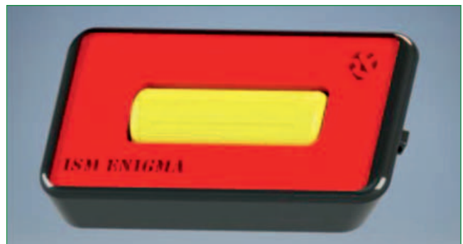
Fig. 4 – L'E-Key Energy Harvester di ISM Enigma è un interruttore che da semplici movimenti ricava energia sufficiente per emettere un segnale RF utilizzabile come comando a distanza
