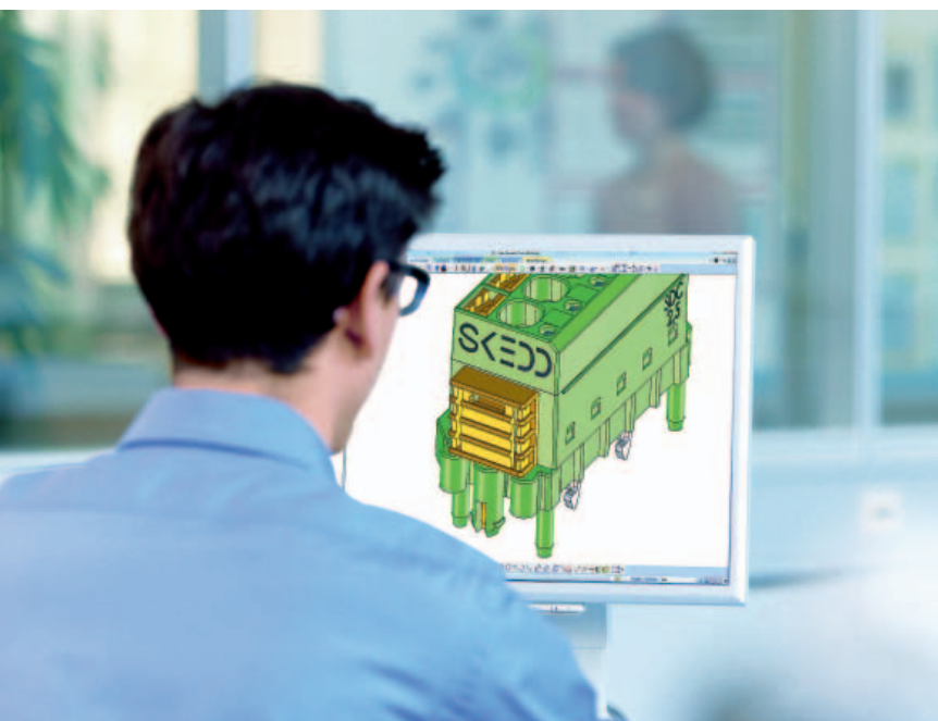
Fig. 1 – I nuovi connettori con tecnologia di connessione a innesto SKEDD di Phoenix Contact possono essere inseriti direttamente e senza utensili in fori a contatto passante sul circuito stampato
