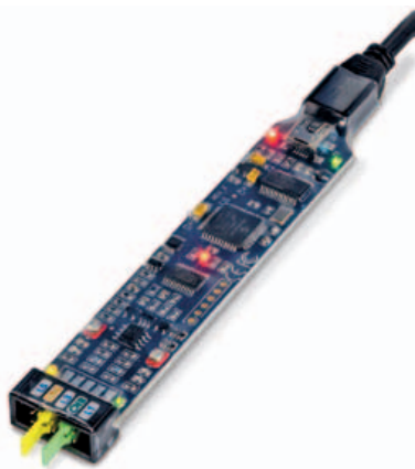
Fig. 2 – BitScope Micro unisce le funzioni di oscilloscopio, analizzatore logico e generatore di forme d'onda in una penna d'alluminio impermeabile e alimentabile da USB
