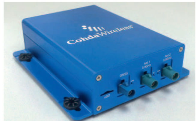
Fig. 3 – Il modulo Cohda Wireless MK5-OBU per le reti V2X conformi agli standard 802.11p e 802.11an si può configurare in ambiente Linux
