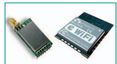
Fig. 6 – Misurano 34,5x20 mm e 15x18,6 mm i modem WT-900M e WT8266-S1 realizzati da Wireless-Tag per le applicazioni IoT basate su collegamenti LoRa fino a 5 km e Wi-Fi fino a 400 m
