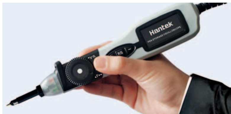
Fig. 6 – L'oscilloscopio a penna Hantek pso2020 si collega alla USB dei computer ma si usa e si configura con una sola mano per misurare i segnali da 20 mV/div a 50 V/div
