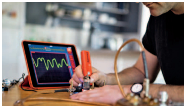
Fig. 1 – Aeroscope ha una banda di 100 MHz che può acquisire 500 Mcampioni al secondo e non ha fili perché comunica in Bluetooth con i sistemi iOS
