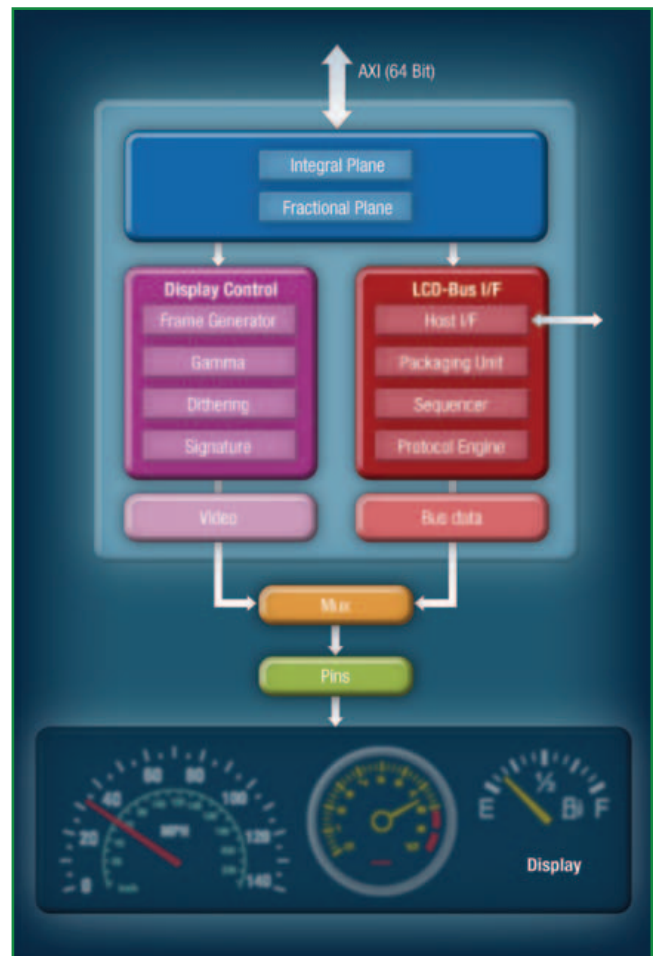
Fig. 3 – Nelle MCU della serie Traveo il controllore del display e il controllore del bus LCD condividono i medesimi pin
