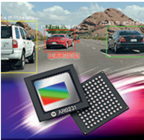
Fig. 2 – Il nuovo sensore d'immagine On Semiconductor AR0231AT ha 2,3 Megapixel BSI e incorpora la tecnologia LED Flicker Mitigation grazie alla quale offre una risoluzione progressiva HDR di 1080p a 40 fps
