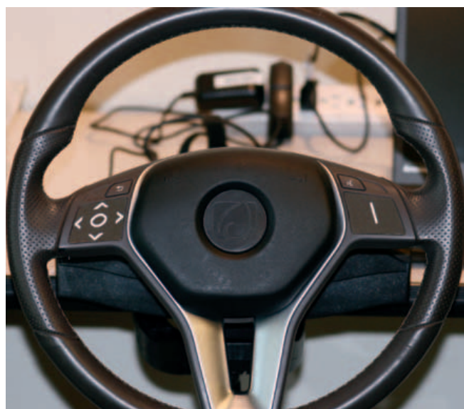
Fig. 3 – Dimostrazione del concetto di touchpad sul volante sviluppato da Synaptics con funzioni di rilevamento della forza e riscontro aptico (Fonte: Synaptics)
