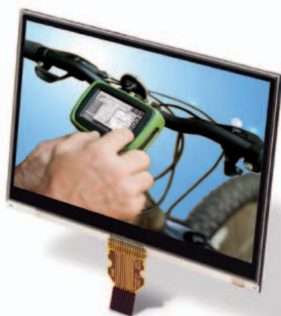
I display Sharp Memory in Pixel offrono un eccellente contrasto e un'ottima leggibilità anche sotto la luce solare intensa pur consumando pochissima energia (Fonte: Sharp Devices Europe, Thinkstock)
