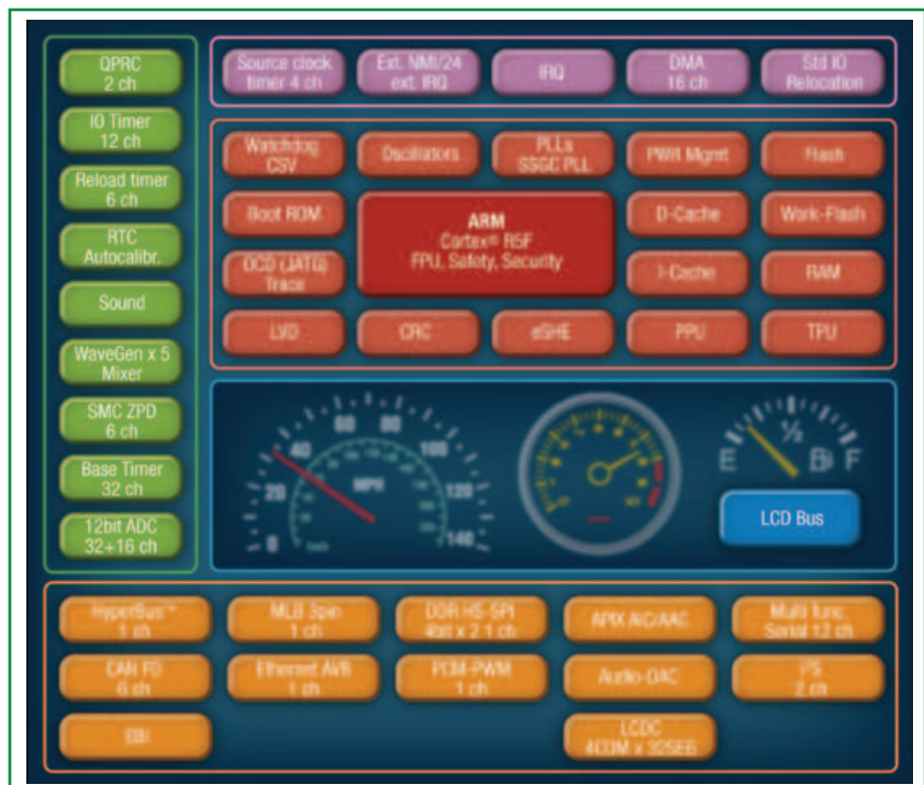
Fig. 2 - Schema a blocchi dei microcontrollori S6J331X/S6J332X/S6J333X/S6J334X della serie Traveo di Cypress Semiconductor
