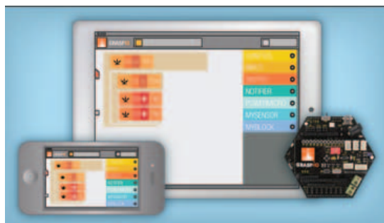
Fig. 2 – Il tool GraspIO consente di progettare graficamente su smartphone e tablet i sistemi IoT costruiti su una SmartDevBoard con sopra sensori, motori, display, camere e componenti custom
