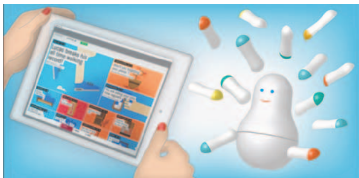
Fig. 5 – La piattaforma Open.Sen.se permette di inventarsi una rete IoT domestica configurando le funzionalità dei sensori Motion Cookies e la gestione in tempo reale da parte della Mother centrale
