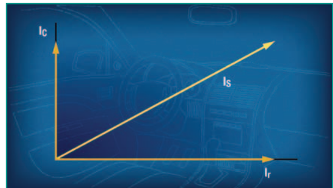
Fig. 2 – Diagramma di fase che mostra le due componenti della corrente di pilotaggio del sensore Capsic
