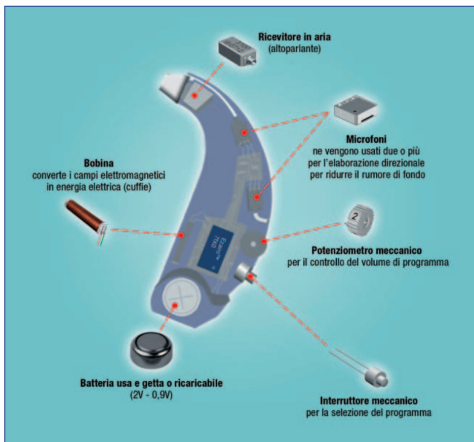
Fig. 3 – La tipica forma a guscio dell'apparecchio acustico impone stretti vincoli di spazio
