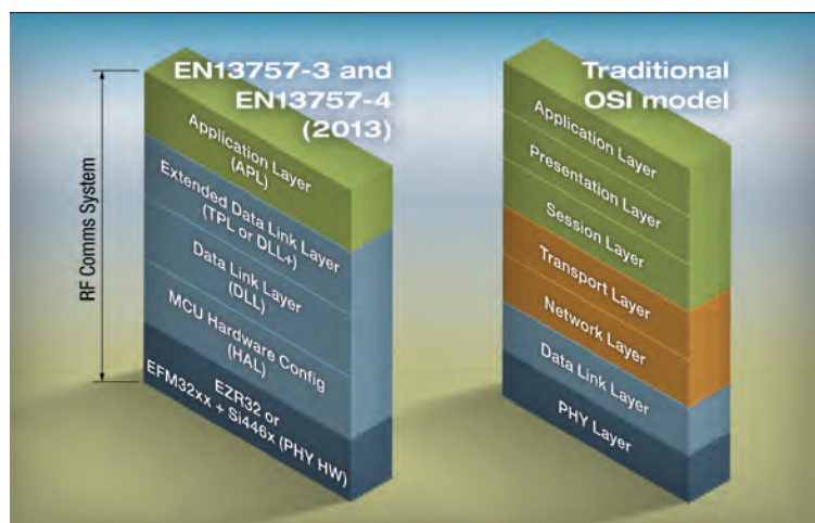
Fig. 2 – Confronto tra le caratteristiche dello stack di Wireless M-Bus e i livelli del modello OSI
