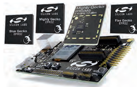
Fig. 6 – Le tre famiglie Blue, Mighty e Flex del Wireless Gecko Portfolio di Silicon Labs consentono di realizzare reti domotiche interoperabili con connessioni miste Bluetooth Smart, ZigBee e Thread
