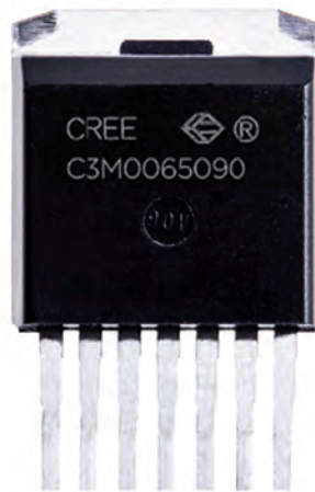
Fig. 2 – La tecnologia planare dei C3S Mosfet in SiC realizzati da Cree consente un'erogazione di 32A a 900V con una resistenza di conduzione di 65 m \Omega a 25°C che viene contenuta a 90 m \Omega alla massima temperatura operativa di 150 °C
