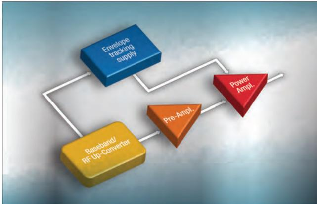
Fig. 5 - Schema a blocchi di un Envelope Tracking System
