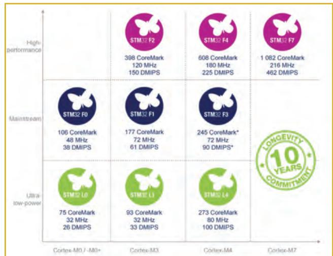
Fig. 4 – La famiglia STM32 di STMicroelectronics è composta da tre sottofamiglie ottimizzate in funzione delle particolari esigenze applicative
