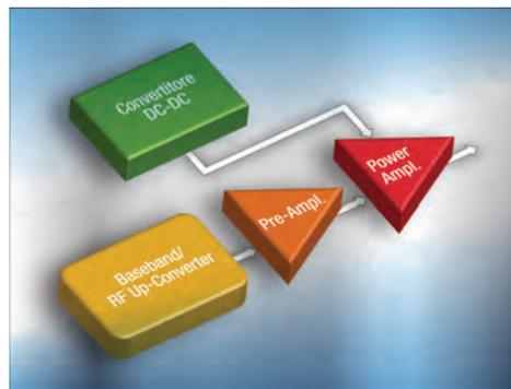
Fig. 3 - Schema a blocchi di un amplificatore RF tradizionale
