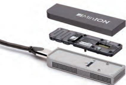
**Fig. 2 – MinION di Oxford Nanopore consente di estrarre le sequenze del DNA con semplici ed economici test alla portata di tutti**
