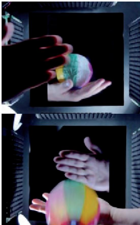
Fig. 1 – HaptoClone realizzato nei Makino Lab dell'Università di Tokyo aggiunge agli ologrammi la percezione aptica che consente di toccarli
