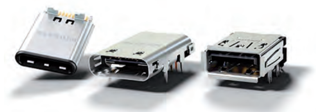
Fig. 1 – Garantiscono una velocità dati di 10 Gbps i connettori Alysium A46-4825/2245 USB 3.1 Gen 1 di tipo C e A con trasporto di alimentazione rispettivamente di 15 e 9 W
