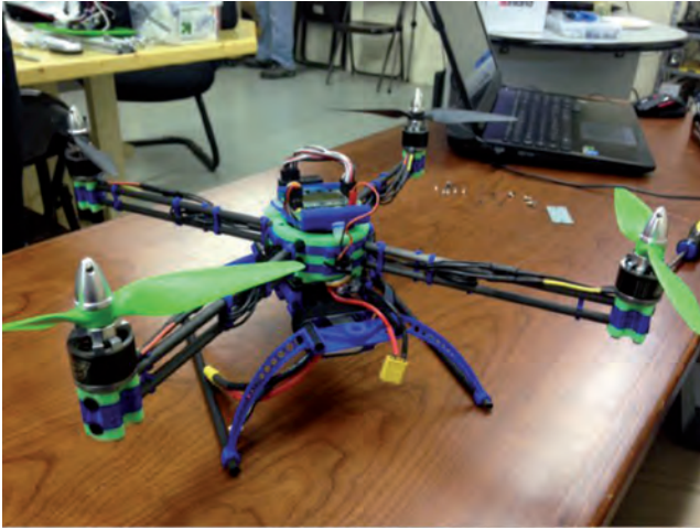
Fig. 2 – Quadricottero in fibra di carbonio costruito a partire da componenti stampati in 3D
