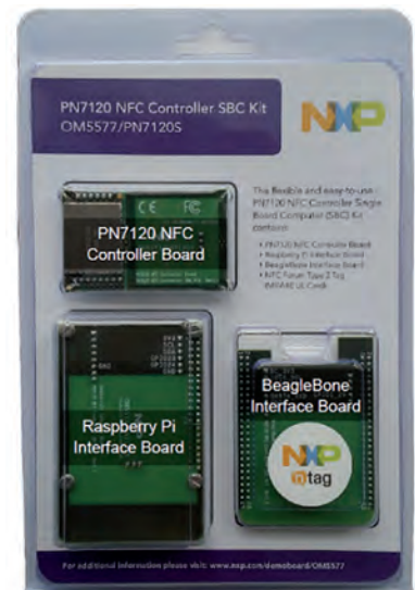
Fig. 4 – SBC Kit consente di sviluppare applicazioni per Smart Home con il nuovo chip d'interfaccia NFC PN7120 pensato da NXP per Linux e Android
