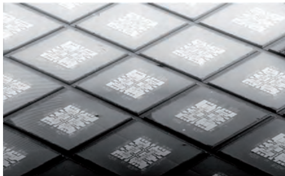
Fig. 1 – Gli switch MEMS sono più affidabili rispetto agli switch a semiconduttore nel gestire l'elevata energia dei segnali a radiofrequenza e hanno meno problemi d'implementazione circuitale
