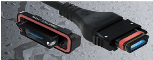
Fig. 5 – I connettori Omnetics Quick Lock USB 3.0 hanno caratteristiche rugged con un'impedenza di 90 Ohm e perdite d'inserzione contenute in -2,8 dB@2,5 GHz alla velocità di 5 Gbps
