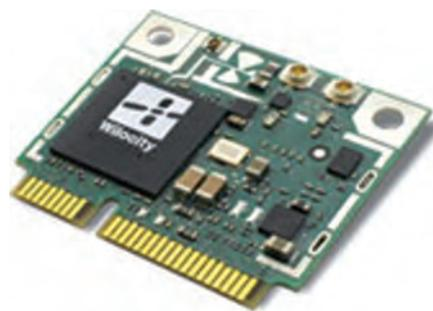
Fig. 3 – Una mini scheda PCI Express 60 GHz all'interno di un ultrabook
