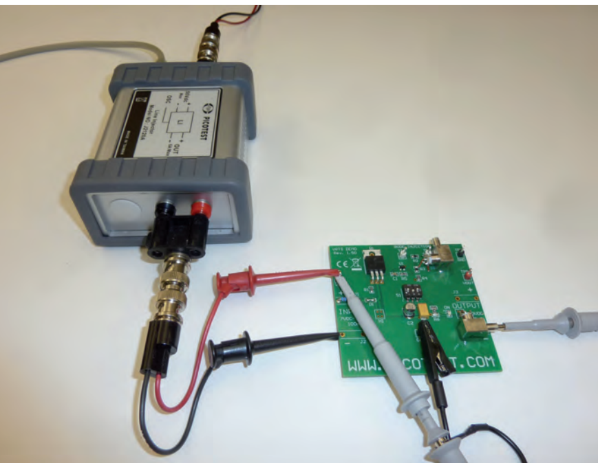
Fig. 3 – Caratterizzazione di un convertitore DC-DC tramite due canali dell'oscilloscopio
