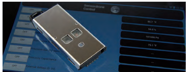
Fig. 3 – Il sensore ambientale all-in-one ha rappresentato un banco di prova per le tecnologie dei sensori “collegati”
