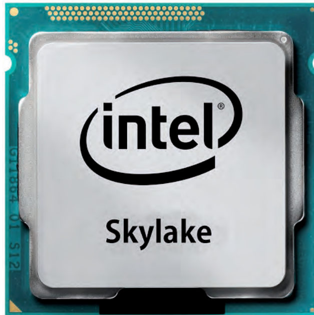
Fig. 3 – I nuovi processori con architettura Skylake in geometria di riga da 14 nm saranno fanless e avranno otto core con clock di 4 GHz e una GPU riprogettata
