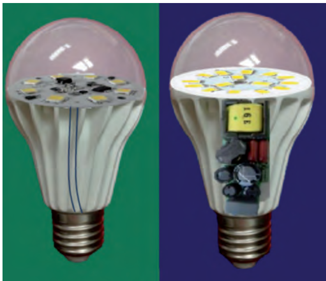
Fig. 3 – Una lampada a LED che utilizza uno schema di regolazione diretta in AC (a sinistra) e uno che impiega un alimentatore SMPS (a destra)
