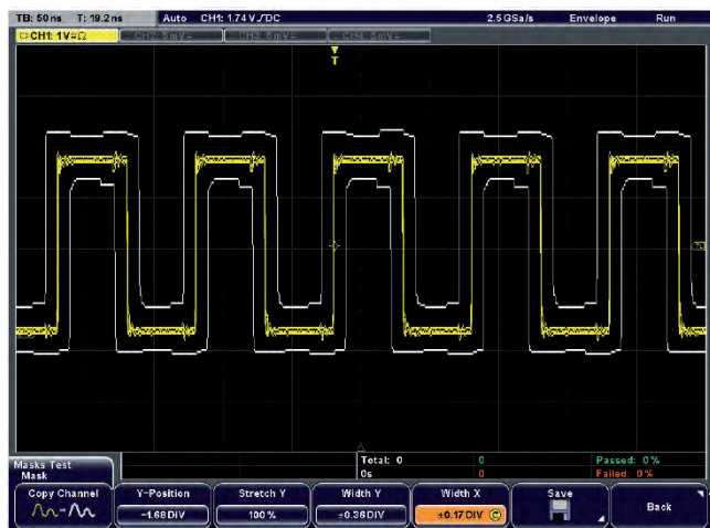
Fig. 7 – Mask Test: la definizione delle maschere sulla base di opportuni segnali di riferimento
