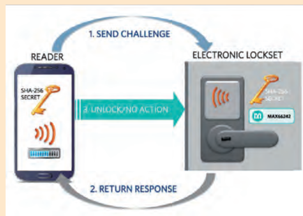
L'autenticazione della serratura elettronica con tecnologia NFC/RFID è basata sul tag passivo MAX66242
