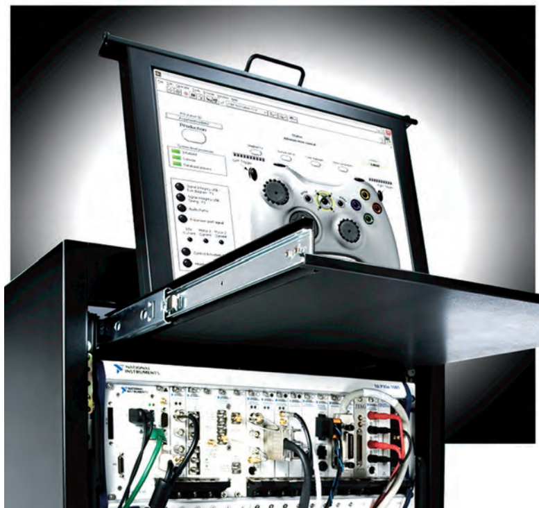
Fig. 1 – Microsoft ha creato una rete di tester per continuare a migliorare i test funzionali
