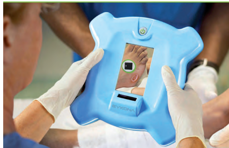
Fig. 4 – Lo scanner portatile Scanify di Fuel3D cattura delle immagini stereoscopiche tridimensionali molto utili sia nel medicale sia per la replica dei prototipi con stampa 3D
