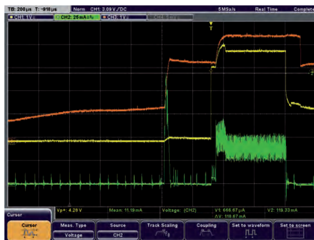
Fig. 5 – Comportamento in accensione che mostra un picco di potenza insieme all'attivazione della pompa di carica
