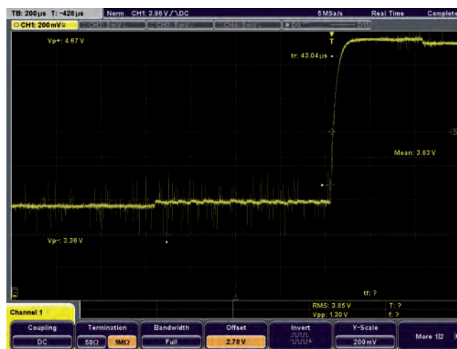
Fig. 4 – Tempo di salita misurato sulla tensione erogata dal driver a un LED
