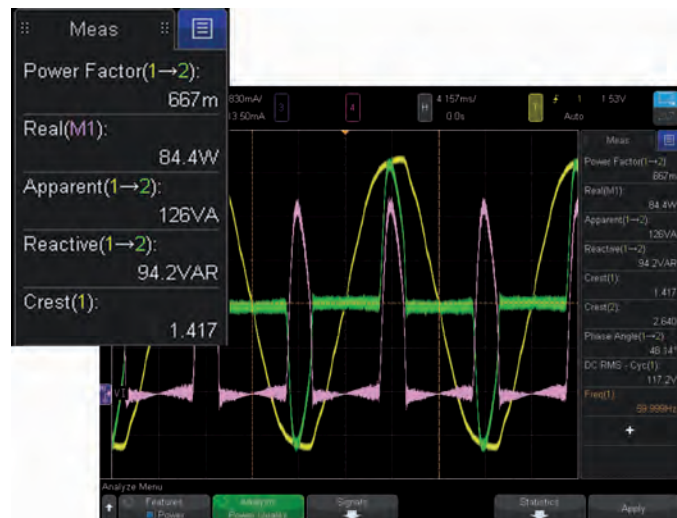
Fig. 1 – Esecuzione automatica di una misura di qualità dell'alimentazione con un oscilloscopio dotato di un'opzione dedicata alle misure di potenza
