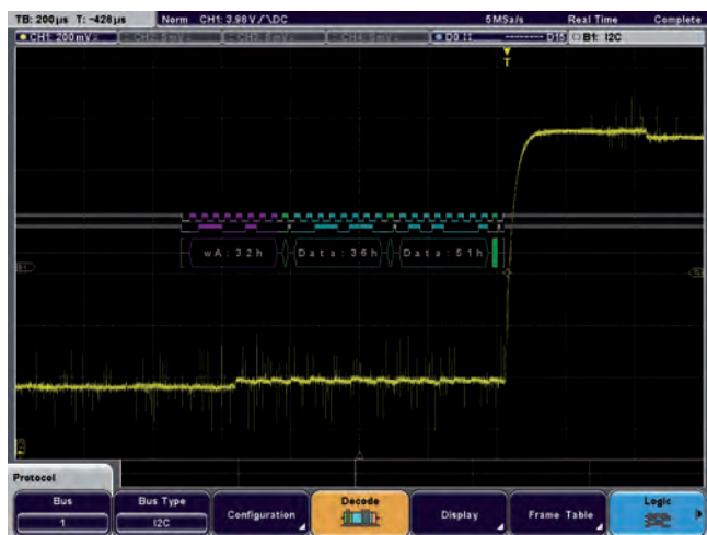
Fig. 3 – Comandi I2C e segnali d'uscita nel test su un driver per LED
