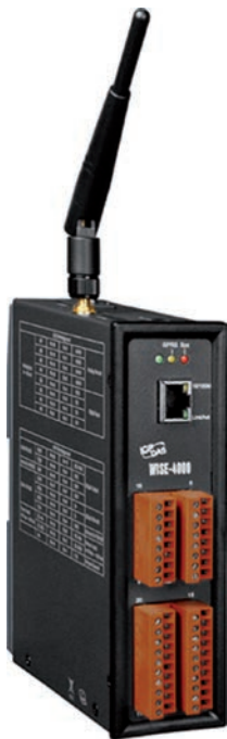
Fig. 5 – Modulo intelligente WISE (Web Inside, Smart Engine) di Sistemi Avanzati Elettronici, per il controllo remoto via SMS, con interfaccia Web, 3 canali di ingresso digitali, 8 canali di ingresso analogici, 3 canali di uscita digitali
