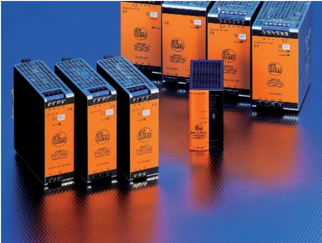
Fig. 2 – La famiglia degli alimentatori IFM da 24V offre sette modelli per un'erogazione in corrente che va da 3,3 fino a 20A e un'efficienza energetica che va dall'89,8% al 94,8%
