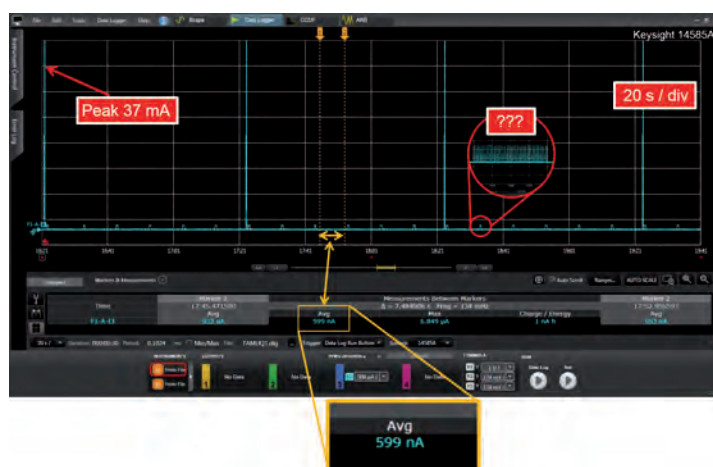
Fig. 4 - L'assorbimento di corrente registrato per 200 secondi di funzionamento mostra i dettagli sul consumo dinamico del dispositivo
