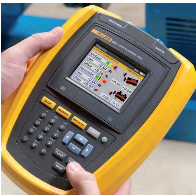
Fig. 2 – Il tester Fluke 830 ha un laser rosso che consente di verificare l'allineamento degli alberi rotanti e visualizzare i risultati sull'ampio display con una risoluzione inferiore al micron
