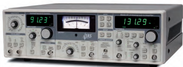
Fig. 2 – L'Analog Lock-In Amplifier SR124 di SRS ha una banda di misura che va da 0,2 Hz a 200 kHz, 100 dB di dinamica e una sensibilità in tensione che va da 100 nV a 500 mV
