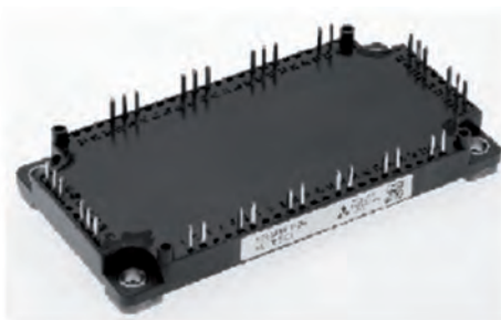
Fig. 8 – IGBT CM100TX-24S serie NX di Mitsubishi
