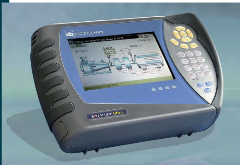
Fig. 3 – Nuovo firmware per il tester laser “all-in-one” Totalign Ultra iS di Prüftechnik che permette di valutare i disallineamenti anche sulle macchine installate verticalmente tipicamente malagevoli
