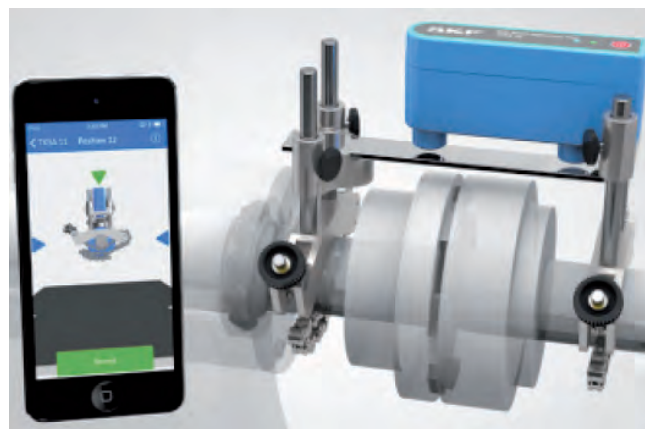
Fig. 4 – Sfrutta due sensori di prossimità induttivi il tester portatile TSKA 11 che consente di visualizzare su smartphone il disallineamento degli alberi con risoluzione di 10 µm grazie a una comoda ed economica app
