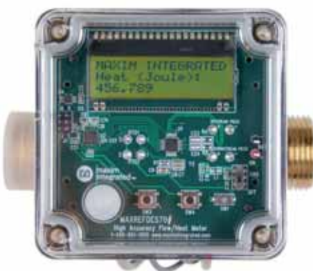
Fig. 1 – Il Reference Design MXREFDES70 di Maxim, un flussimetro a ultrasuoni che utilizza la tecnica del "time of flight"
