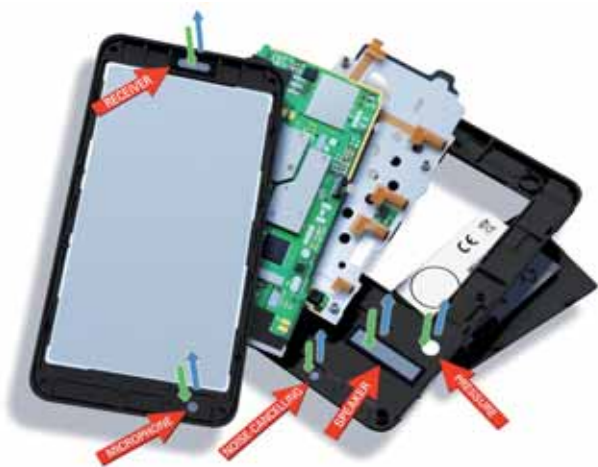
Fig. 1 – Punti in cui uno smartphone può essere vulnerabile alla penetrazione di particelle e liquidi, nonché alle improvvise variazioni di pressione e di temperatura
