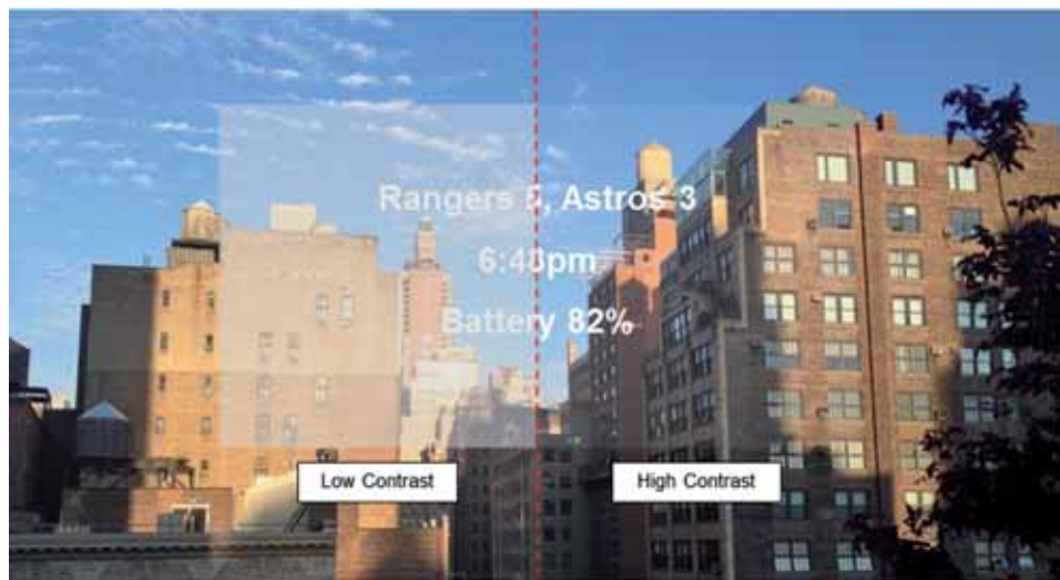
Fig. 2 – Questa immagine illustra l'impatto del rapporto di contrasto su qualità e leggibilità dell'immagine (l'immagine è una simulazione e non è ricavata da un sistema NED reale)
