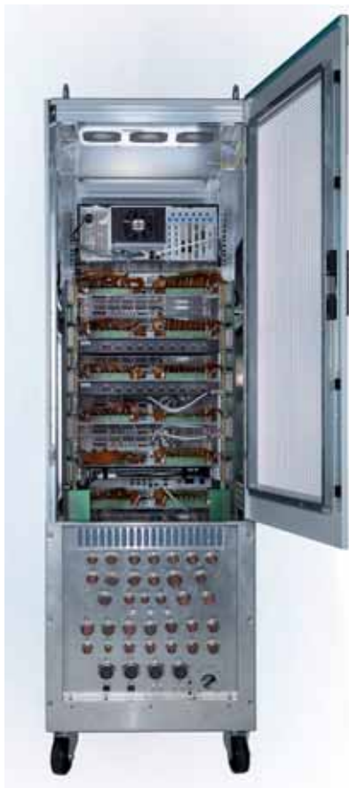
Fig. 1 – La piattaforma di test sviluppata da Siemens CVC Aerospace prevede l'uso di schede PCB come metodo principale di interconnessione al posto dei cablaggi tradizionali
