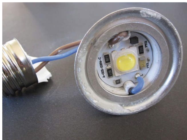
Fig. 4 – Una volta smontata, la lampada Retrofit aperta permette di visionare il circuito elettrico LED sviluppato
