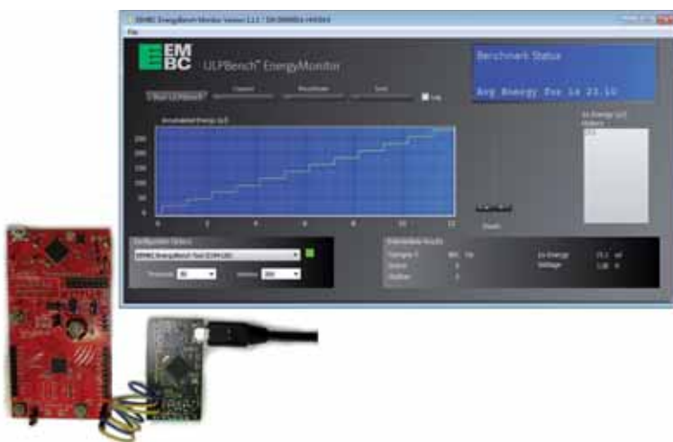
Fig. 2 – Schermata di una fase di test generata dal tool EnergyMonitor attraverso una GUI ULPBench. L'energia misurata durante la cattura di una finestra è illustrata nel grafico Graph interno al CoreProfile
