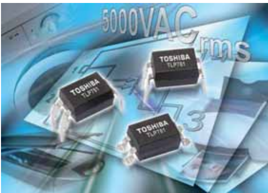
Fig. 6 – L'optoaccoppiatore Toshiba TLP781 ha un LED in ingresso e un fototransistor nello stadio d'uscita con tensione fino a 80 V e tolleranza termica estesa da -55 a +110 °C
