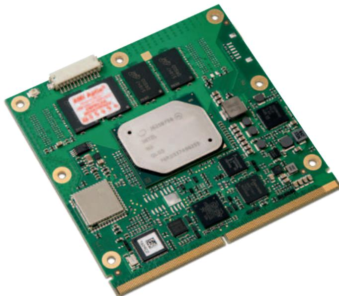
**Fig. 2** - Questo modulo ad alto grado di integrazione conforme a SMARC 2.0 di dimensioni pari a 80x80mm, prodotto da MSC, è in grado di supportare tre display indipendenti, ospita memorie DDR3, eMMC, SATA Flash e interfacce USB 3.0, oltre a un modulo per la comunicazione wireless
