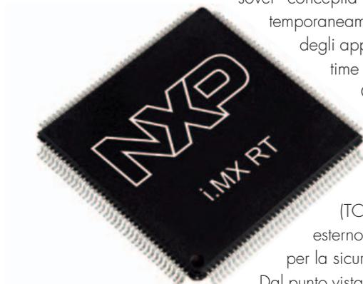
Questa serie di processori è basata sul core ARM Cortex-M7 a 600MHz e, dal punto di vista delle prestazioni, sono in grado di fornire un CoreMark score di 3020, 1284 DMIPS e 20ns di latenza nella risposta agli interrupt. Per quanto riguarda l'architettura, questi componenti integrano, fra l'altro, 512KB di Tightly Coupled Memory (TCM) SRAM, e un convertitore DC-DC che elimina la necessità di un PMIC esterno. Non mancano un engine per la cifratura AES-128 e altri accorgimenti per la sicurezza.
