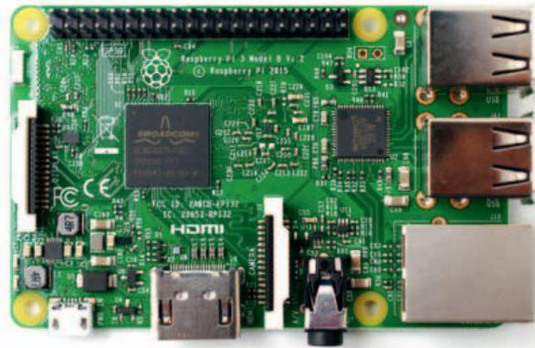
**Fig. 7 - L'ultima versione Raspberry Pi 3 con CPU quad-core ARMv8 a 64 bit monta i transceiver Bluetooth 4.1/BLE e WLAN e supporta Windows 10 IoT**
