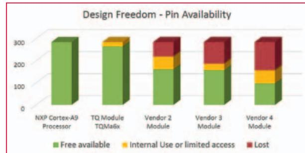
**Fig. 2 - Disponibilità di pin comparando vari moduli sul mercato**
