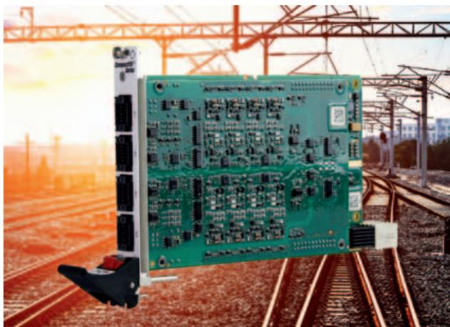
**MEN** ha introdotto una nuova scheda 3U in formato CompactPCI Serial espressamente ideata per l'uso nelle moderne applicazioni ferroviarie. Dotata di 16 canali di I/O digitali bidirezionali, la scheda G403 può espletare numerose funzioni di controllo, come ad esempio quello della chiusura delle porte o dell'illuminazione interna.
