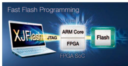
Utilizzando XJFlash, sia i nuovi clienti, sia quelli esistenti, sperimentano tempi di programmazione fino a 20 volte inferiori rispetto alle soluzioni disponibili per la configurazione di memorie connesse a SoCs FPGA forniti dai leader del settore, come Xilinx Zynq e Altera Cyclone V SoC, che dispongono di processori dual ARM Cortex-A9.
