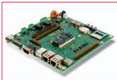
**Fig. 4 - STKa6ULx: baseboard di sviluppo per TQMa6ULx**
