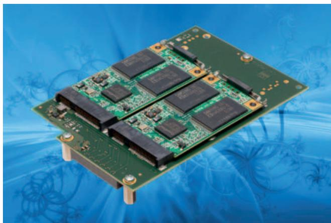
**Fig. 3 - La scheda mezzanina C47-MSATA con i due connettori host ben visibili**
