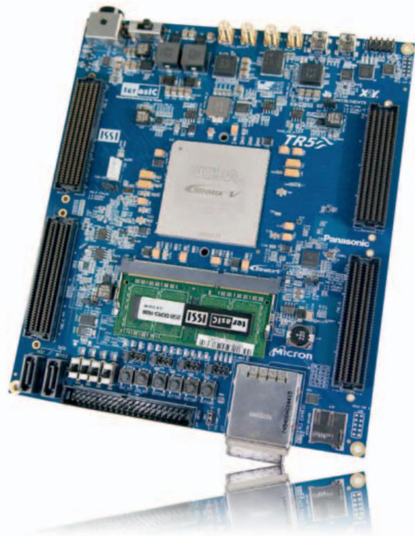
**Fig. 1 - Il kit di sviluppo FPGA TR5 di Terasic utilizza gli FPGA della linea Stratix V GX di Intel PSG (Altera)**
