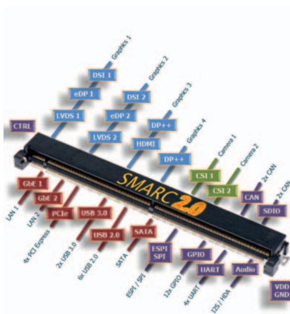
Fig. 1 - I segnali previsti dallo standard SMARC 2.0 sul connettore MXM-3 a 314 pin
