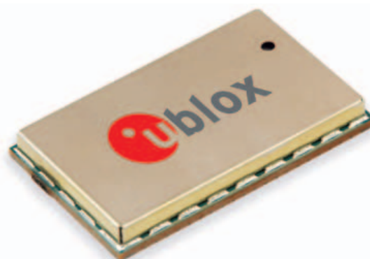
Fig. 1 - Il modulo cellulare compatto SARA-U2 sviluppato da u-blox
