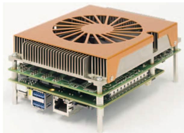
Fig. 1 - Tutti i progetti di server embedded sviluppati sfruttando il concetto di Server-on-Modules sono caratterizzati da dimensioni molto ridotte, che possono essere di soli 125x95 mm
