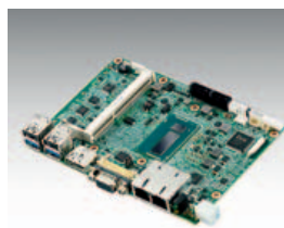
Fig. 1 - L’SBC (Single Board Computer) da 3,5” MIO-5271 di Advantech basato sul core di quarta generazione della serie U dispone di quattro interfacce seriali, due alloggiamenti mPCIe e una connessione per LAN Ethernet
