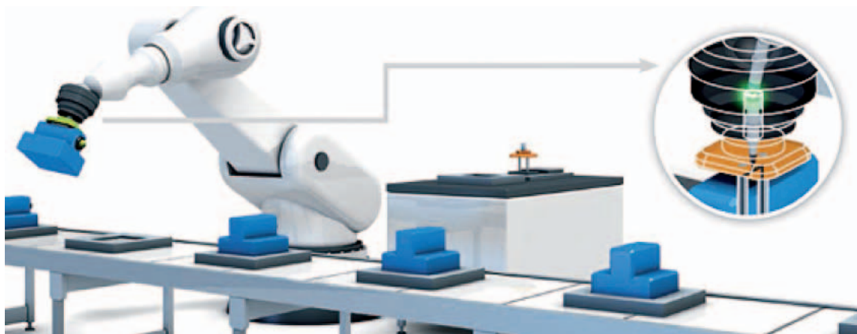
Fig. 4 - L'utilizzo della connettività senza contatto su un braccio robotizzato consente una libertà di movimento di 360° senza provocare l'usura delle spazzole tipica dei progetti ad anello collettore correnti (Immagine: TE Connectivity)
