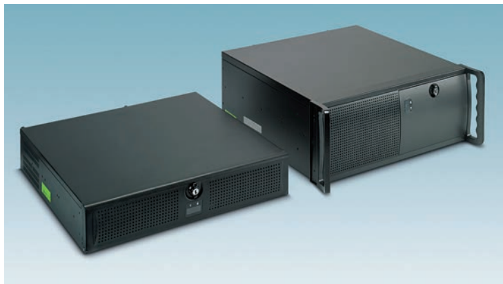
Fig. 2 - Due PC industriali in formato rack 19", adatti ad applicazioni di acquisizione, misura, visualizzazione ed elaborazione di grandi volumi di dati (Fonte: Phoenix Contact)
