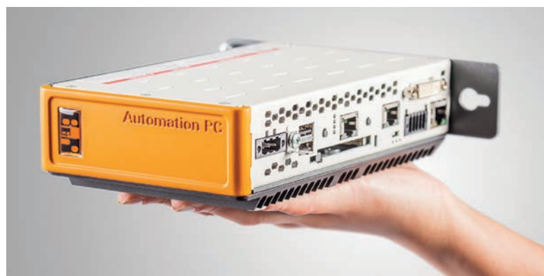
Fig. 1 - Un computer industriale equipaggiabile con processori single core, dual core o quad core (Fonte: B&R)
