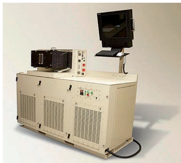
Fig. 2 - La piattaforma Northrop Grumman NGATS AN/TSM-271 consente la verifica in linea delle schede embedded industriali in tutte le loro caratteristiche elettriche e ottiche
