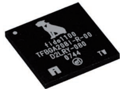
Fig. 1 - Fido 1100 è un controller esplicitamente ideato per garantire una comunicazione flessibile e un'elaborazione deterministica
