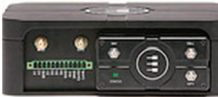
ReliaGATE 10-20 è un gateway con opzioni di connettività flessibili per applicazioni Internet of Things
