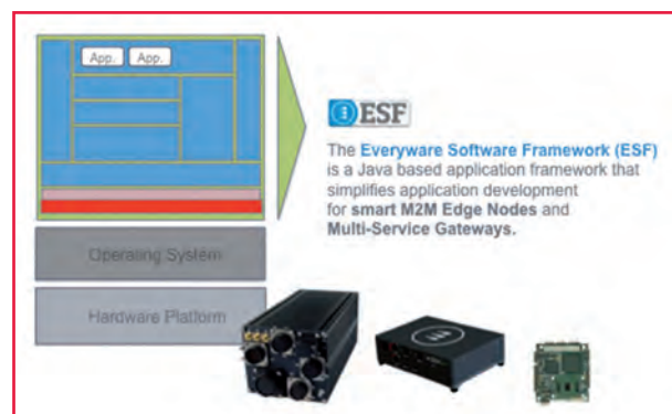
Fig. 2 - ESF (Everyware Software Framework) è l'infrastruttura software Java OSGi per gateway multiservizi e dispositivi "intelligenti" M2M di Eurotech
