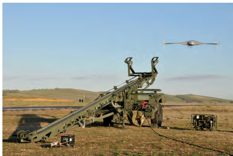
Fig. 1 - Bat, un velivolo UAS (unmanned aircraft system) di Northrop Grumman, e il suo sistema di lancio
