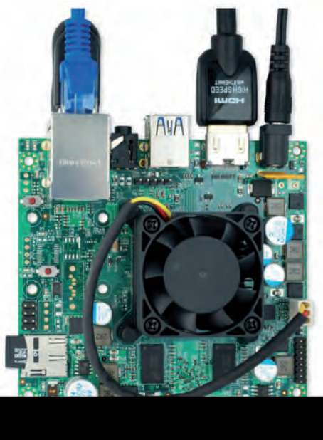
Fig. 3 - Nella GizmoSphere Gizmo 2 c'è un'APU AMD dual-core GX0210HA insieme a una GPU AMD Radeon HD8210 per una potenza di elaborazione grafica di 85 GFLOPs
