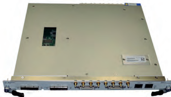
Fig. 9 - M9521A AXIe di Keysight
