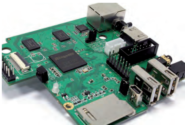
Fig. 2 - È pensata per le applicazioni Linux e Android la scheda MIPS Creator CI20 che ha una CPU Ingenu con architettura MIPS32 e le interfacce Ethernet, Bluetooth e Wi-Fi 802.11b/g/n
