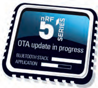
Fig 2 - Con l'aggiornamento OTA (Over The Air) del firmware del dispositivo nRF51822, il firmware del beacon può essere aggiornato sul campo
