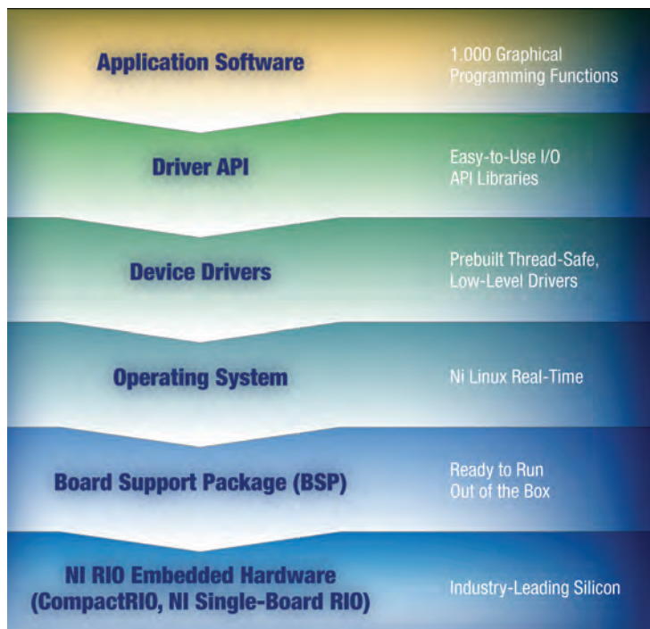
Fig. 3 - NI SOM integra un BSP (board support package) validato e driver di dispositivo con NI Linux Real-Time
