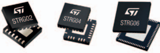
Fig. 2 – ST è all'avanguardia nel settore dei chipset per la gestione della potenza per la nuova architettura che prevede la conversione da 48V alla tensione richiesta dai punti di carico per i server rack dei data center
