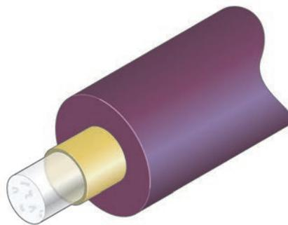
**Fig. 1 - Struttura delle fibre HPCF a guaina singola**
