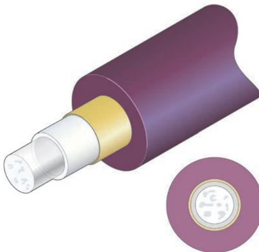
**Fig. 2 - Struttura delle fibre HPCF a doppia guaina**
