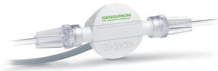
**Fig. 6 - La tecnologia CMOSens caratterizza il sensore di flusso liquido usa e getta Sensirion LD20-2000T con range di misura da 0 a 5 ml/min e risoluzione di 0,1 nl/min**
