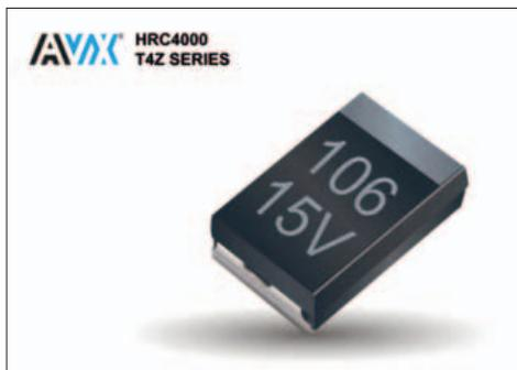
della serie T4Z Medical sono attualmente disponibili in otto dimensioni, valori di capacità che vanno da 0,1  $\mu$ F a 330  $\mu$ F, otto valori di tensione standard compresi tra 4 e 50 V e temperature operative nominali che vanno da -55 °C a + 125 °C. Questi componenti sono stati progettati per sostituire i condensatori commerciali in dispositivi medicali non critici che richiedono una elevata affidabilità come per esempio cardiografici, neurostimolatori, pompe per insulina e mo-
