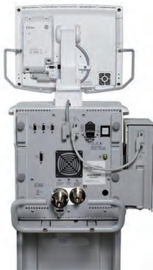
**Il dispositivo di acquisizione dati Engström EView di GE Healthcare è equipaggiato con il computer embedded TurboXb di Eurotech**
