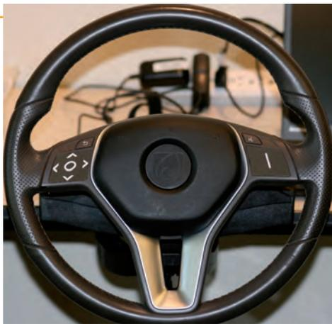
**Fig. 3 – Dimostrazione del concetto di touchpad capacitivi direzionali sul volante sviluppato da Synaptics (Fonte: Synaptics)**
