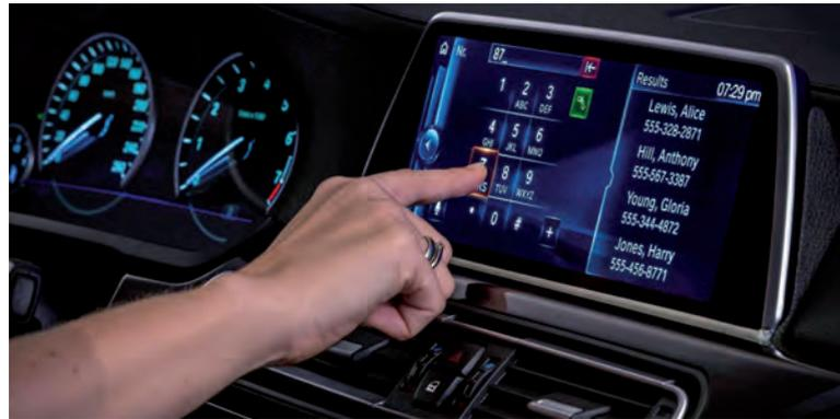
**Fig. 2 – iDrive di BMW è un esempio di display con touchscreen capacitivo montato a bordo di una moderna automobile (Fonte: Synaptics)**
