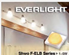
possono essere pilotati a 1W tramite una corrente operativa di 350 mA oppure fino a 5W con una corrente di 1500 mA. Il flusso luminoso a 1W è superiore a 165 lm (152lm/W) con temperatura colore di 6500K oppure si possono ottenere 130 lm (120 lm/W) a 3000K quando i LED pilotati con una corrente di 350 mA.
