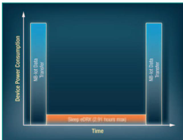
Fig. 3 – La modalità eDRX permette di ridurre il consumo di energia
