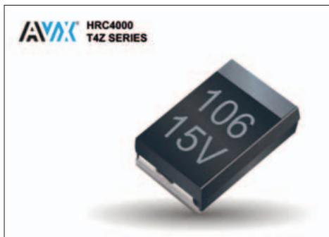
della serie T4Z Medical sono attualmente disponibili in otto dimensioni, valori di capacità che vanno da 0,1  $\mu$ F a 330  $\mu$ F, otto valori di tensione standard compresi tra 4 e 50 V e temperature operative nominali che vanno da -55 °C a + 125 °C. Questi componenti sono stati progettati per sostituire i condensatori commerciali in dispositivi medicali non critici che richiedono una elevata affidabilità come per esempio cardiofrequenzimetri, neurostimolatori, pompe per insulina e mo-
