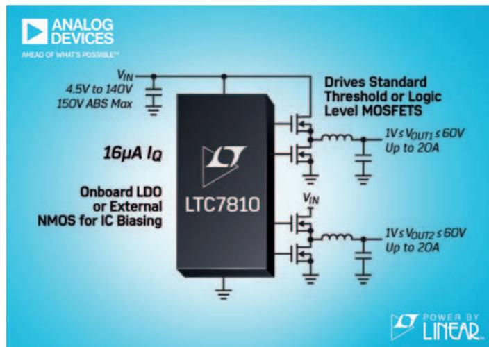
esterno tra 75 kHz e 720 kHz. Sono disponibili due intervalli termici di funzionamento, per le versioni industriale ed estesa, con temperature di giunzione da -40° C a 125° C e una versione automotive per alte temperature da -40° C a 150° C.
