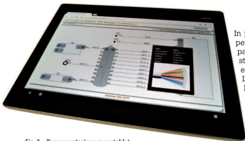
**Fig. 2 – Rappresentazione su un tablet ottenuta mediante browser Web di uno schema circuitale che riporta i dettagli relativi ai cablaggi**
