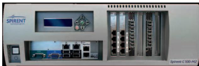
Fig. 3 – Spirent Landslide consente di emulare migliaia di nodi di rete wireless e valutare la correttezza dei trasferimenti attraverso i gateway anche per i nuovi segnali NB-IoT e CAT-M
