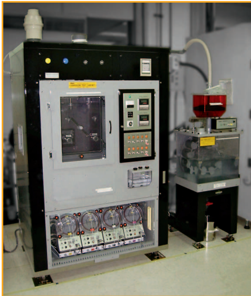
Fig. 3 – Una camera di test Everlight dove sono simulati gli effetti dello zolfo sui componenti
