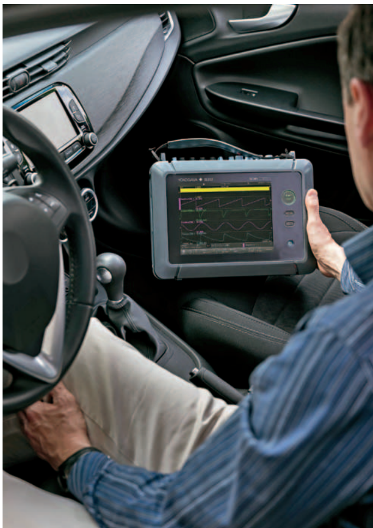
Fig. 2 – La possibilità di decodificare i segnali LIN e CAN rende particolarmente interessante questo strumento per l'industria automotive
