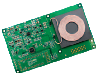
Fig. 2 – I due nuovi Reference Design Rohm BD57020MWV e BD57015GWL consentono d'implementare la ricarica a induzione magnetica negli apparecchi di bassa e media potenza certificati Qi fino a 15W
