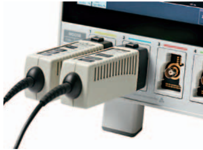
Fig. 2 – Per default, l'ingresso è un connettore TekVPI+ che accetta tutte le sonde analogiche TekVPI ma, nel momento in cui è connessa la nuova sonda logica TLP058, l'ingresso è convertito in 8 canali digitali
