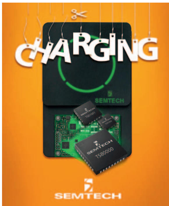
Fig. 3 – La piattaforma di ricarica induttiva Semtech Tri-Mode TS80K consente di scalare nella potenza di ricarica da 100 mW fino a 100W in funzione delle applicazioni
