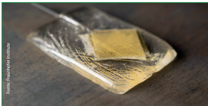
Il sensore piezoelettrico per alte temperature realizzato dal Fraunhofer ISC può essere usato per applicazioni fino a 900 gradi
