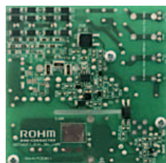
Fig. 2 – Vista superiore e inferiore della scheda di valutazione AUX e relativi parametri elettrici principali
