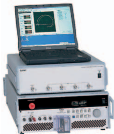
Fig. 2 – Il Fuel Cell Testing System NF As-510-4 ha un modulo base per i test EIS con potenza fino a 100 W e due unità specifiche per la valutazione dell'impedenza e delle caratteristiche degli elettrodi
