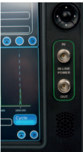
Fig. 6 – Power Meter passante
