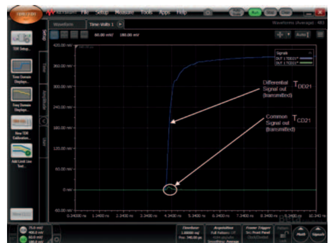
Fig. 6 – Conversione di modo nel canale (Alto: Sono state catturate entrambe le risposte, differenziale e di modo comune; Basso: Ingrandimento della risposta di modo comune e indicazione che le tracce sono state catturate con differenti tempi di salita del segnale di stimolo)
