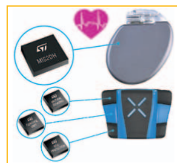
Fig. 5 - L'accelerometro impiantabile STMicroelectronics MIS2DH permette di monitorare la postura e i movimenti dello scheletro mentre un sensore inerziale a 9 assi e l'MCU STM32F24 montati sulle fascette XMetrics aiutano i nuotatori a migliorare il proprio stile
