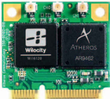
Fig. 5 – Scheda WiGig Dell MiniPCIe basata su chip Wilocity e Atheros
