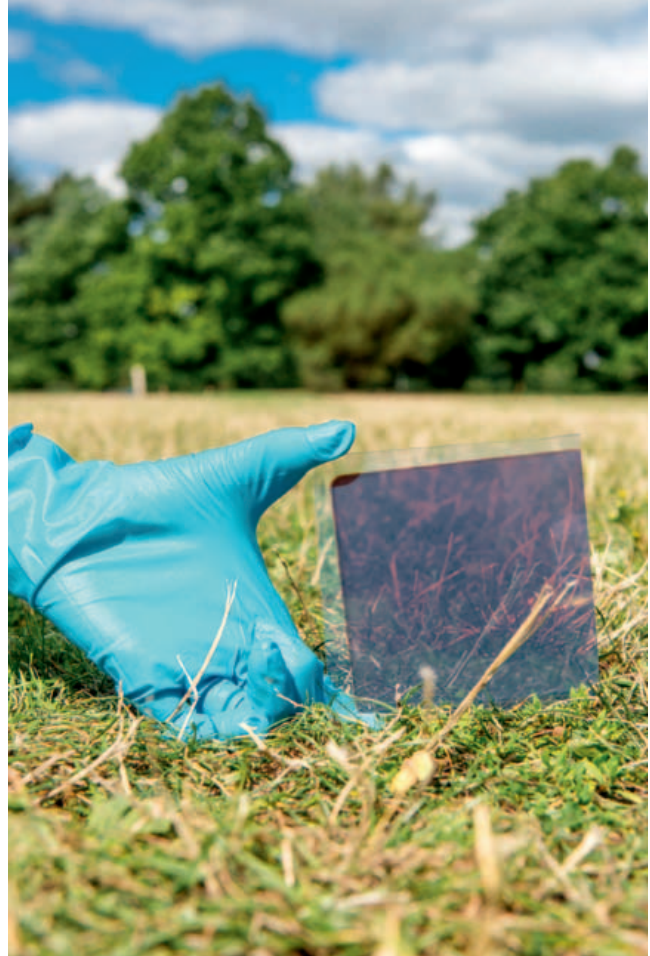
Fig. 4 – Cella solare realizzata con perovskite a ioduro di piombo-metilammonio su vetro
