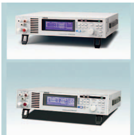
Fig. 1 – Gli Impedance Meter Kikusui KFM2005 e KFM2030 eseguono test EIS sulle Fuel Cell con scansione fra 10 mHz e 10 kHz e risoluzione di 100 mΩ selezionabile fino a 0,5A, 5A o 30A
