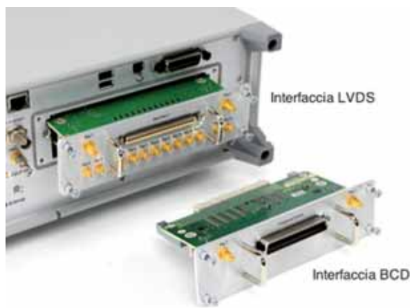
Fig. 3 – Interfaccia BCD o LVDS
