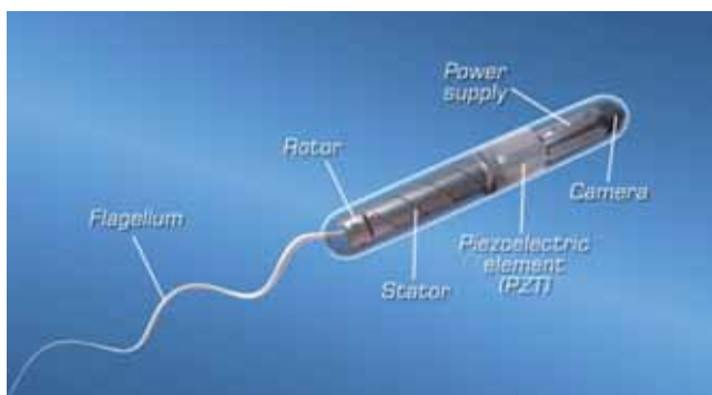
Figg. 3-4 – La struttura e le modalità d'impiego del microrobot Proteus
